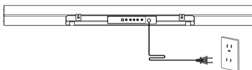
将音箱连接至市电，打开电源，LED灯亮，音箱开机。
