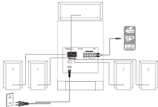
注意：1、音箱连接线的颜色，黑色线接入红色接线夹，白黑色线接入黑色接线夹。
