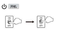
如图所示，向上拨动开关，顶部指示灯亮，系统开机并发出提示音；
