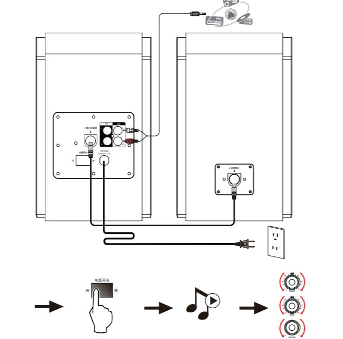
1. 将音箱连接线连接主副音箱。
